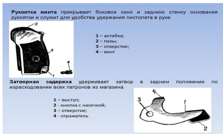
Рис. 22. Рукоятка с винтом. Затворная задержка
