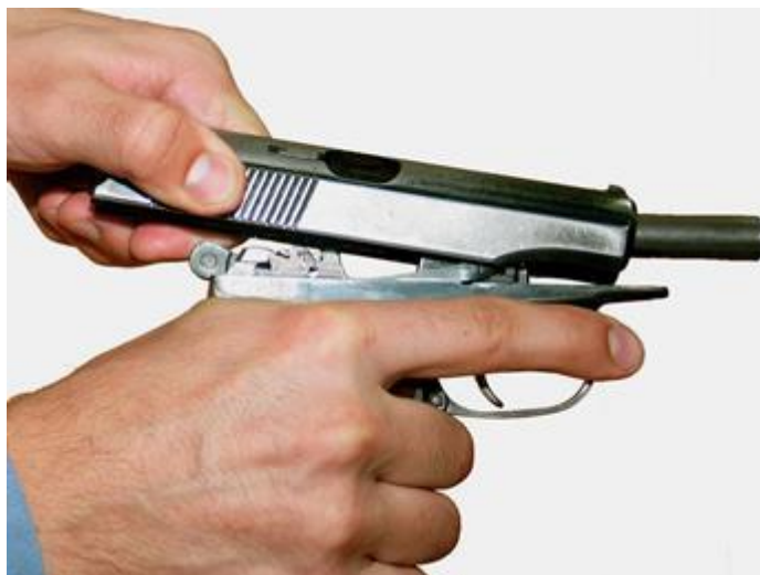
Рис. 8. Присоединение затвора к рамке.
