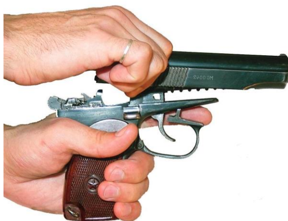
Рис. 7. Введение свободного конца возвратной пружины в канал затвора
