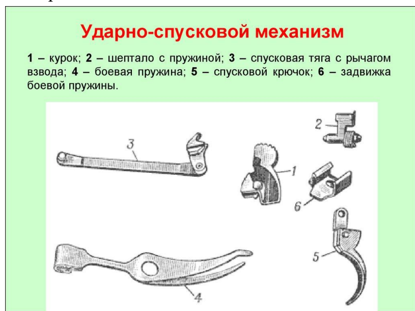
Рис. 16. Части ударно-спускового механизма
