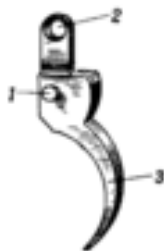
Рис. 20. Спусковой крючок: 1 цапфа; 2 отверстие; 3 хвост
