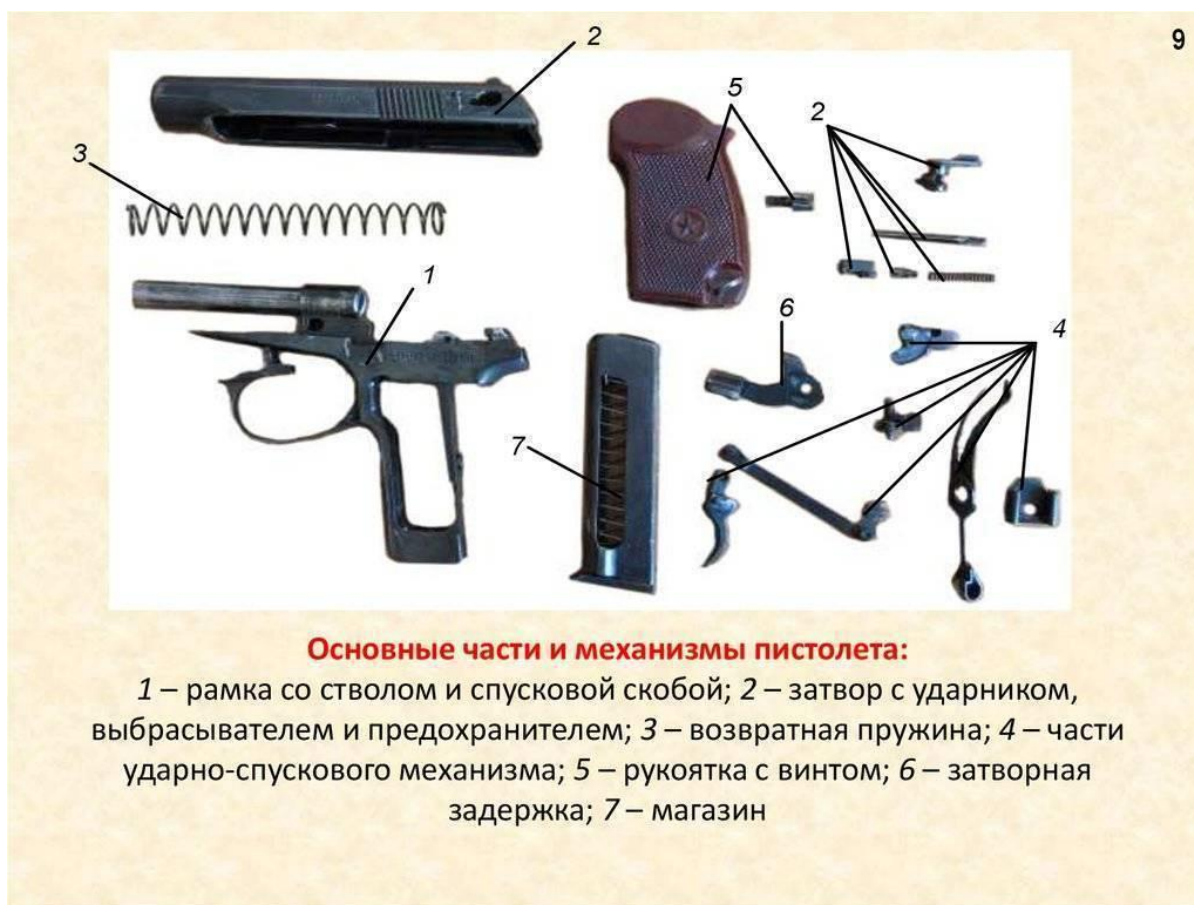
Рис. 2. Основные части и механизмы пистолета:
