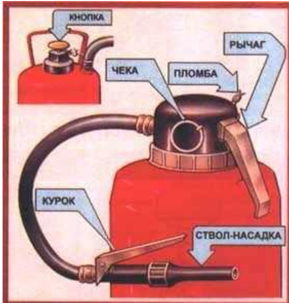
Рис.3. Порошковый огнетушитель со встроенным источником давления.
