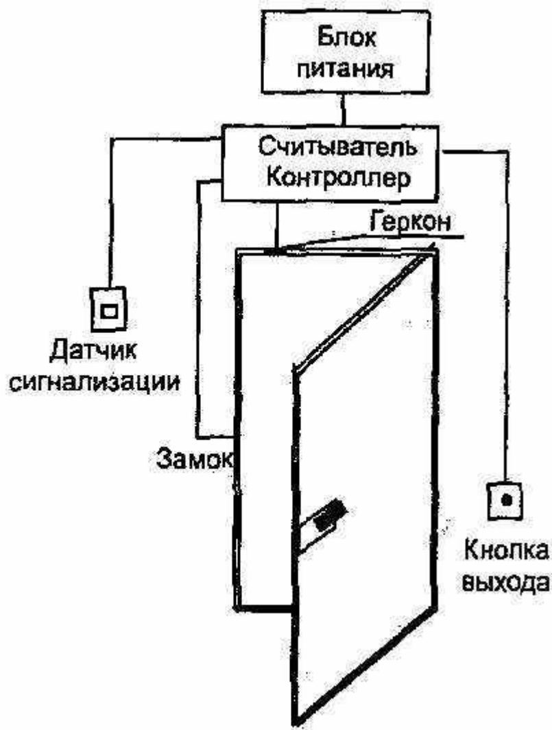
Рис.2 Схема системы с совмещенным контролером и считывателем.
